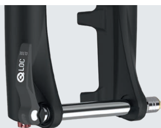
15QLC32S Ø15mm, O.L.D.: 100mm Weight: 108g
