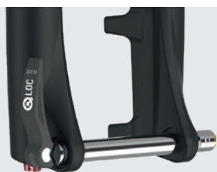
15QLC32S Ø15mm, O.L.D.: 100mm Weight: 108g
