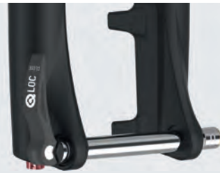
15QLC32S Ø15mm, O.L.D.: 100mm Weight: 108g
