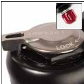
LO R: Zugstufenverstellung + Lockout an der Gabel
