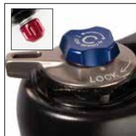
**LO RC:** 回弹调节+低速气压调节+油压锁定 (加氮气)
