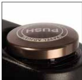
**TA:** 回弹调节+低速气压调节+线控锁定
