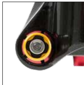
OLC: Q-LOC-2, sistema patentado de cierre rápido por eje pasante
