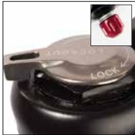
LO R: Ajuste de rebote + bloqueo
