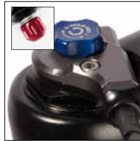
RL RC: Ajuste de rebote + Ajuste de compresión a baja velocidad + Bloqueo remoto.
