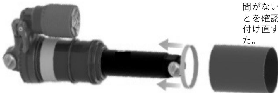
3. 必要な量のエアボリュームスペーサーを追加または取り外します。メインボディを取り付け直し、隙間がないように密閉されていることを確認します。Oリングを取り付け直すと乗車の準備が整いました。
