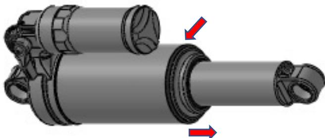
1. メインボディからすべての空気を抜きます。エアキャンバーの下にあるOリングを取り外します。Oリングを傷つけないように注意してください。
