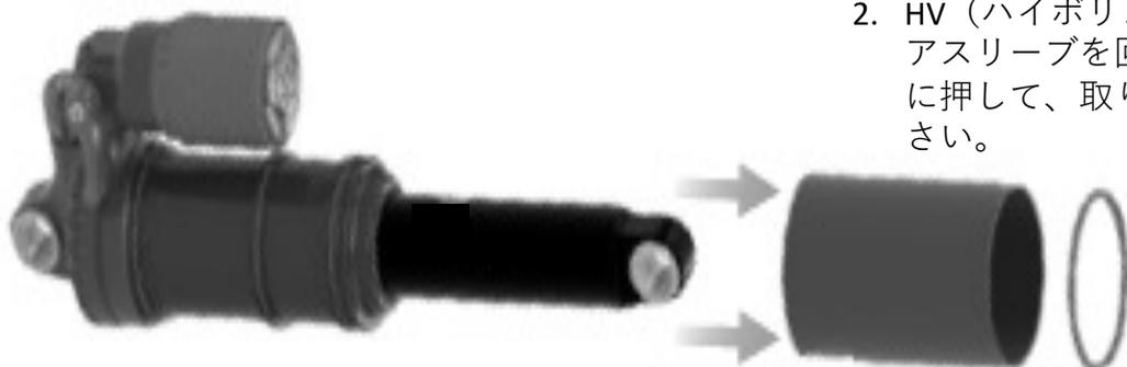
2. HV（ハイボリューム）エアスリーブを回しながら下に押し、取り外してください。
