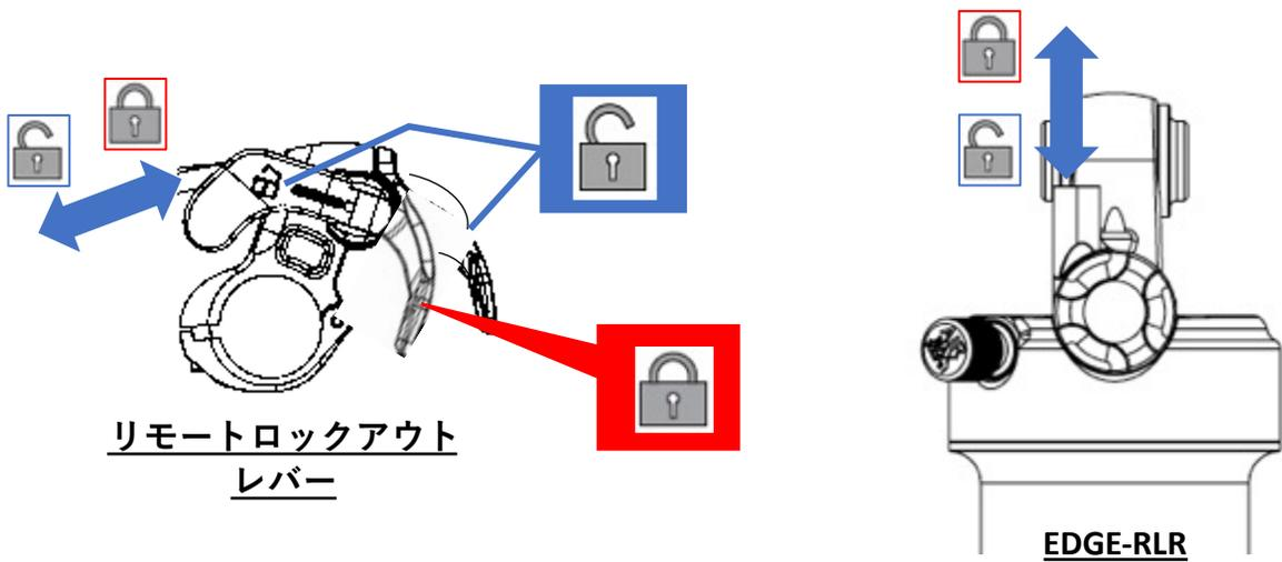
Tハンドルバーから手を離すことなくグリップを握りながら、ハンドルバーのリモートレバーからリモートロックアウト機能の操作を行うことができます。リモートレバーはロックとロック解除機能を有します。ロックアウト機能は、大きな衝撃やダウンフォースの力が発生しノーズダイブのようになるような状況を防止します。衝撃力がカートリッジのブローオフ回路の抵抗を超えると、衝撃は吸収されます。ロックアウト機能を使用すると、滑らかな地面や起伏のある地形で、ポンピング状態を防ぎ、最大のペダリング効率を実現します。
