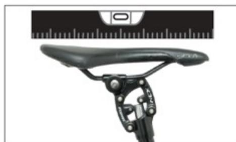
5. Stringere il bullone di fissaggio con una chiave a brugola da 5mm. La coppia di serraggio consigliata è di 15-18Nm.
