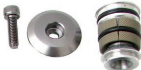
1 × Boulon Allen M6 1 × Capuchon supérieur 1 × Écrou à expansion
