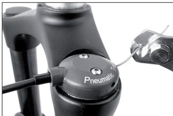
Instale un tapón de cierre de cable en el extremo del cable cortado utilizando unas pinzas.
