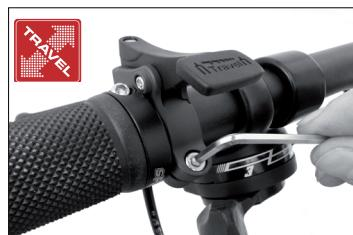
Przeprowadź linkę przez zatyczkę zewnętrznej obudowy i przez zacisk linki. Napnij lekko linkę i zamocuj ją przy użyciu klucza imbusowego 2 mm.
