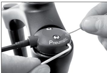
Corte el cable en la longitud correcta. Se recomienda cortar a aproximadamente 12 mm.
