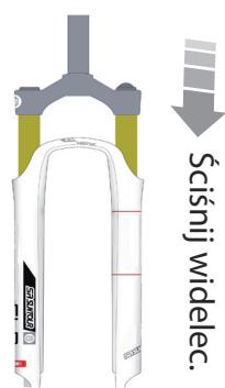
**REGULACJA TŁUMIENIA KOMPRESJI****SERIA DUROLUX RCA**
