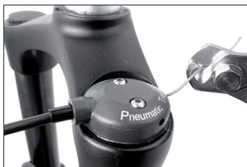
Zamontuj nakładkę na końcówkę linki na końcu przeciętej linki przy pomocy kominerek z wąskimi końcówkami.
