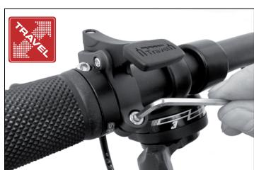
Ziehen Sie den Seilzug durch die äußere Kabelhalterung und durch die Seilklemme. Spannen Sie den Seilzug leicht und ziehen Sie ihn mit einem Inbusschlüssel (2 mm) fest.
