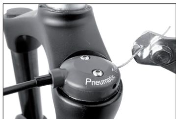
Befestigen Sie mit einer Spitzzange eine Abschlusshülse am Ende des abgeschnittenen Seilzugs.
