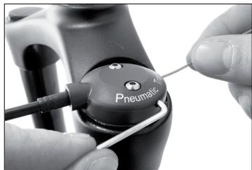
Schneiden Sie den Seilzug auf die richtige Länge zurecht. Eine Länge von ca. 12 mm wird empfohlen.
