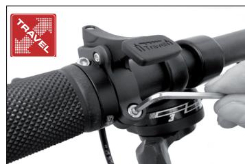
Faites passer le câble par le butoir du couvercle et par le bariillet. Tendre légèrement le câble, puis serrez-le à l'aide d'une clé hexagonale de 2 mm.
