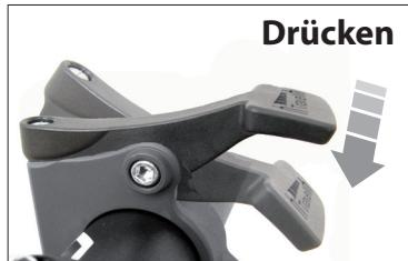
Drücken Sie den Travel Adjust Hebel nach unten und halten Sie ihn gedrückt. Tauchen Sie die Gabel ein. Lassen Sie den Hebel los. Entlasten Sie die Gabel.
