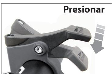
Presione la palanca de Travel Adjust hacia abajo y manténgala ahí. Comprima la horquilla. Suelte la palanca nuevamente. Descargue la horquilla.
