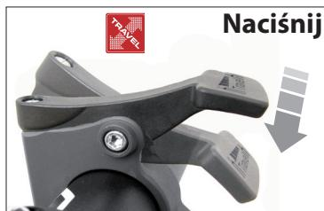
Naciśnij dźwignię regulacji skoku w dół i przytrzymaj ją w tym położeniu. Ściśnij widelec. Puść dźwignię. Zdejmij nacisk z widelca.
