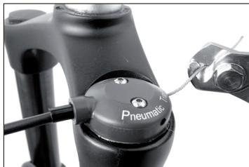
Placez un capuchon de protection au bout du câble, à l'aide d'une pince à bec effilé.
