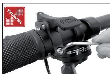
Pase el cable por el obturador de la funda exterior y a través de la abrazadera del cable. Tense ligeramente el cable y sujetelo utilizando una llave Allen de 2 mm.
