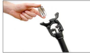
Placez la plaque de fixation supérieure sur le rail de la selle. Faites ensuite passer le crochet entre les deux rails de la selle et sur la plaque de fixation supérieure.
