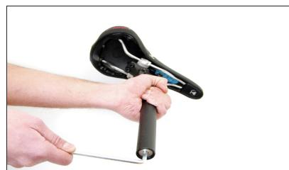
**! No gire el perno del ajustador en sentido contrario al de las manecillas del reloj más allá de la posición inicial. Esto puede ocasionar fallos en el perno del ajustador de precarga y puede barrer las roscas. En esta posición original, deben estar visibles alrededor de 10 mm de la rosca del tubo del sillín.**
