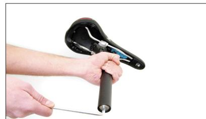
**! Drehen Sie die Einstellschraube auf keinen Fall entgegen den Uhrzeigersinn über die werkseitig eingestellte Position hinaus. Dadurch könnte das Gewinde der Vorlast-Einstellschraube beschädigt werden. In dieser ursprünglichen, werkseitig eingestellten Position sollten etwa 10 mm des Sattelstützen-Gewindes sichtbar sein.**
