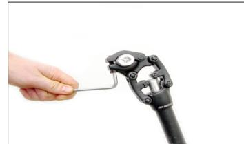
Déposez la plaque de fixation supérieure.
