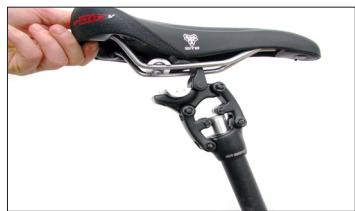
Stellen Sie den Sattel so ein, dass er wie in der Abbildung rechts, horizontal und mittig ausgerichtet ist.
