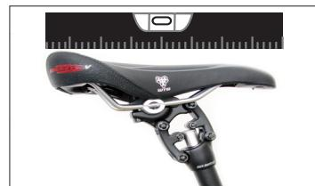
Vissez les deux boulons de fixation à un couple de serrage de 12 Nm à l'aide d'une clé hexagonale de 5 mm.
