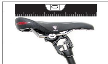
Apriete los dos pernos de fijación a 12 Nm utilizando una llave Allen de 5 mm.
