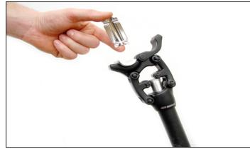
Coloque la placa de la abrazadera superior sobre el riel del sillín. Después dirija la abrazadera a través de los rieles del sillín y sobre la placa de la abrazadera superior.
