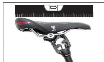
Ziehen Sie die beiden Befestigungsschrauben mit einem 5-mm-Inbusschlüssel auf 12 Nm an.
