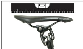
Ziehen Sie die beiden Befestigungsbolzen mit einem 5 mm-Innensechskantschlüssel auf ein Drehmoment von 15-18 Nm an.
