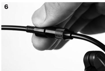
Si la fourche ne se bloque pas, la tension du câble est probablement insuffisante. En ce cas, tendez davantage le câble en tournant la vis de réglage dans le sens antihoraire. Si la tension du câble est excessive et la fourche ne se libère pas, tournez la vis de réglage dans le sens horaire.
