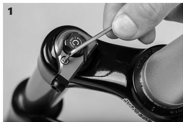
1 Retirez le cache avec une clé Allen de 2,5 mm.
