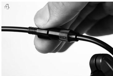
Utilisez un bouchon d'extrémité par mesure de protection contre le bout coupant du câble. Si la fourche ne se bloque pas, la tension du câble est probablement insuffisante. En ce cas, tendez davantage le câble en tournant la molette de réglage du "Lever de blocage à distance" dans le sens antihoraire. Si la tension du câble est excessive et la fourche ne se débloque pas, tournez le vis de réglage dans le sens horaire.
