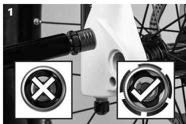
Vérifiez la bride à développer avant l'installation et ouvrez complètement le levier.
