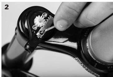
2 Desserrez le boulon de fixation de câble avec une clé Allen de 2 mm.
