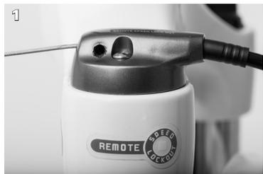
1 Tirez le câble de commande de l'avant à travers le cache.
