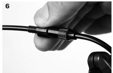
Wenn die Gabel nicht arretiert wird, ist die Spannung des Seilzugs vermutlich zu gering. Erhöhen Sie in diesem Fall die Seilzugspannung, indem Sie die Stellschraube gegen den Uhrzeigersinn drehen. Wenn die Seilzugspannung zu hoch ist und die Arretierung der Gabel nicht gelöst werden kann, drehen Sie die Stellschraube im Uhrzeigersinn.
