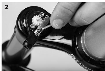
2 Suelte el perno de fijación del cable con una llave Allen de 2 mm.
