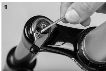
1 Retire la cubierta con una llave Allen de 2,5 mm.
