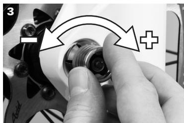
Ajuste la tensión con una palanca semiabierto hasta que la brida quede a nivel con la puntera.
