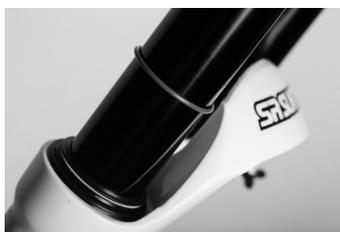
Der empfohlene maximale Luftdruck der Durolux liegt bei 150psi. Dieser Wert sollte nicht überschritten werden.
