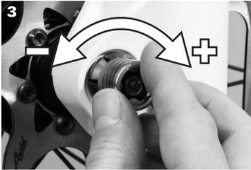
Spannung bei halb geöffnetem Hebel einstellen bis der Flansch anliegt
