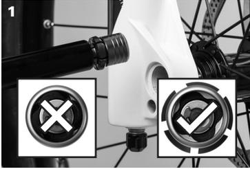
vor dem Einbau den Flansch prüfen und den Hebel komplett öffnen
