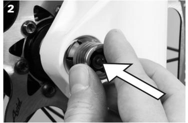
Nuss im Uhrzeigersinn drehen bis Flansch eingerastet bleibt
