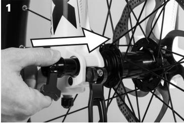
Achse seitens Schnellspanner einschieben
