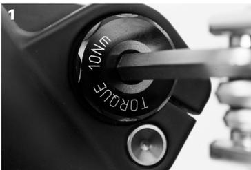
Achse einschieben und mit einem 6mm Inbus und 10 Nm anziehen
