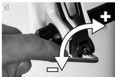
Ajuste la fuerza de tensado con una llave Allen de 4 mm, en caso necesario.
