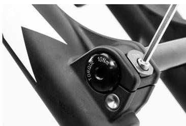
Apriete la sujeción de seguridad con una llave Allen de 4 mm a 7 Nm
