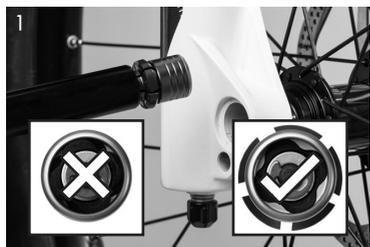
在装置前检查法兰盘是被展开的，将手柄完全的打开。
