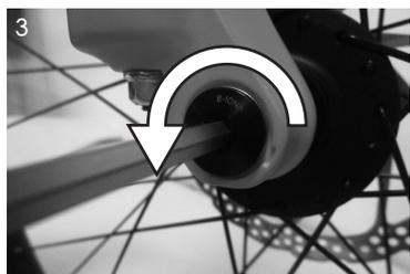
用5mm的内六角扳手在驱动侧松脱锁紧螺丝。
