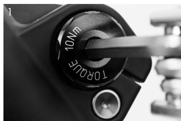
推入车轴，用6mm的六角扳手以10Nm的力将其拧紧。
