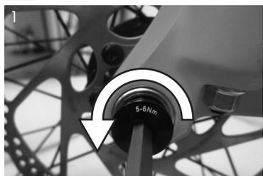
用5mm内六角扳手在非驱动侧松脱锁定螺丝。
