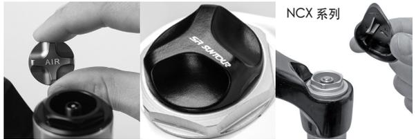
1. 拧下阀盖。将避震前叉气筒拧到阀门上。
