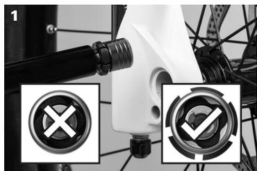
Compruebe la brida que va a expandirse antes de la instalación y abra la palanca completamente.
