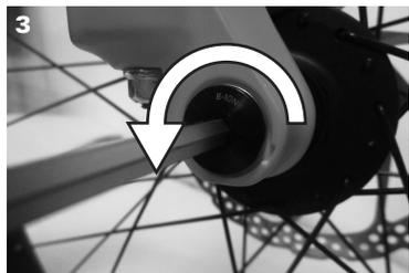
Aflove el eje en el lado de transmisión con una llave Allen de 5mm.
