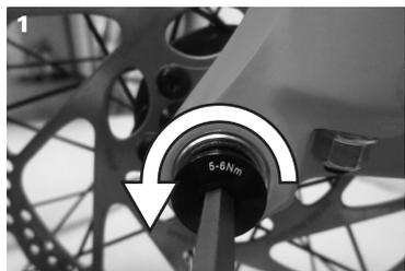
Aflove el tornillo de bloqueo en el lado no de transmisión con una llave Allen de 5mm.
