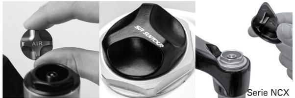
1. Desenrosque la tapa de la válvula. Enrosque una bomba para horquillas / amortiguadores en la válvula.
