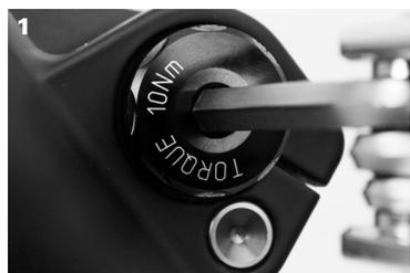
Introduzca el eje y apriételo con una llave Allen de 6mm a 10Nm.
