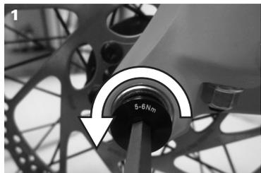
1 Allentare il bullone di bloccaggio sul lato non di trazione con una chiave a brugola da 5 mm.
