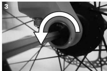
3 Allentare l'asse sul lato di trazione con una chiave a brugola da 5 mm.
