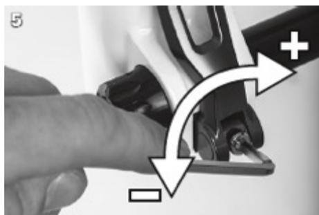
5. Réglez la force de serrage à l'aide d'une clé Allen de 4 mm, si nécessaire.
