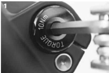
1. Faites entrer l'axe en glissant et serrez-le à 10Nm avec une clé Allen 6mm.
