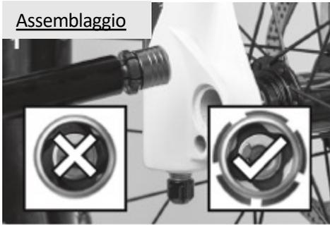
1. Controllare la flangia da espandere prima dell'installazione e aprire completamente la leva.
