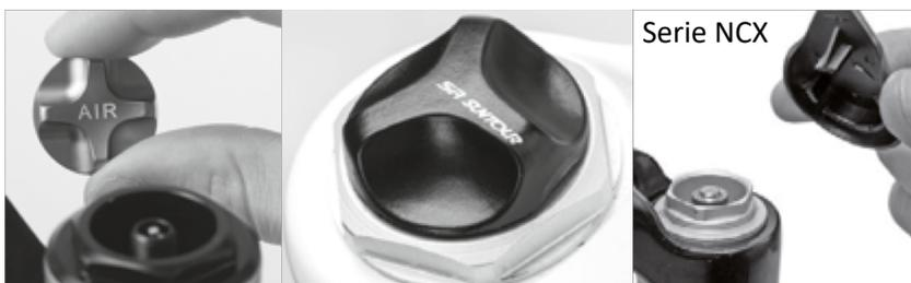
1. Svitare il tappo della valvola. Avvitare una pompa per forcelle / ammortizzatori sulla valvola.
