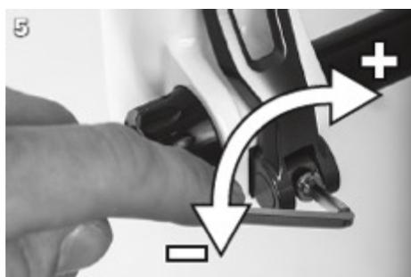
5. Se necessario, regolare la tensione di serraggio con una chiave a brugola da 4mm.
