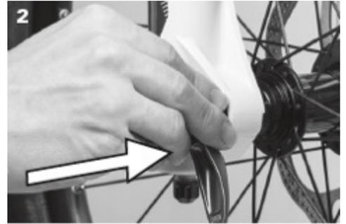
2. 推入筒轴，直至听到“咔嗒”声。确保分段法兰已打开。
