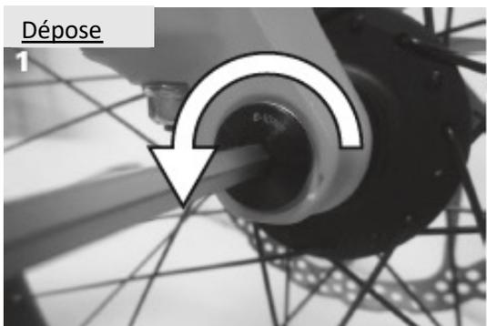
1. Desserrez l'axe côté entraînement avec une clé allen de 6mm (15AH2).
