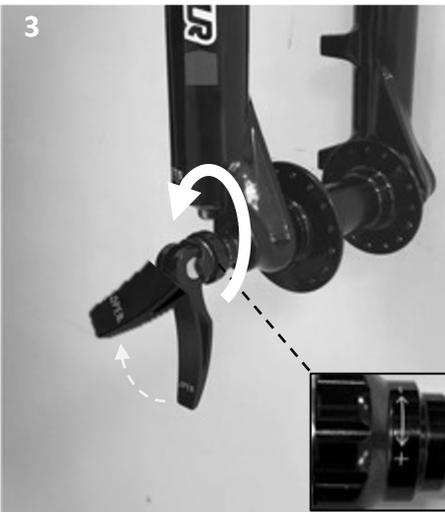
3. Déplacez le levier dans le sens inverse des aiguilles d'une montre pour qu'il pointe en direction du sol. Desserrez l'écrou de réglage (en direction du "-") jusqu'à ce que le levier commence à se positionner à plat. Force de serrage suggérée: 80-120N
