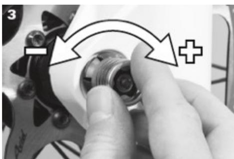
3. Réglez la tension avec le levier semi-ouvert pour que les ailettes soient à ras de l'épaulement).
