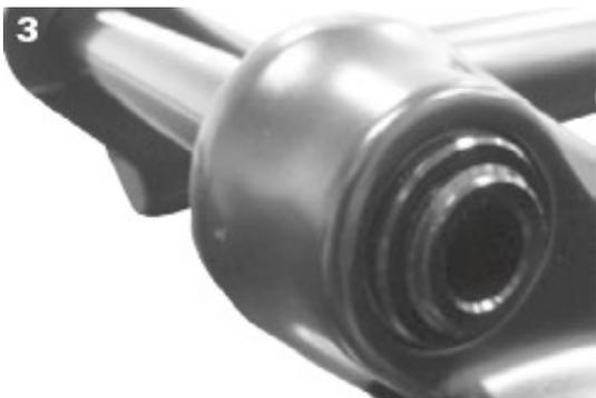
3. Vérifiez le filetage des axes. Il doit être visible.
