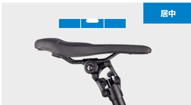
5. 拧紧固定螺栓，使用5mm 内六角扳手，建议的紧固扭矩为15-18Nm。
