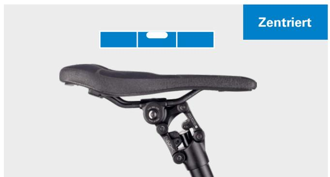
5. Ziehen Sie die Befestigungsschraube mit einem 5-mm-Inbusschlüssel fest. Das empfohlene Anzugsdrehmoment beträgt 15–18 Nm.
