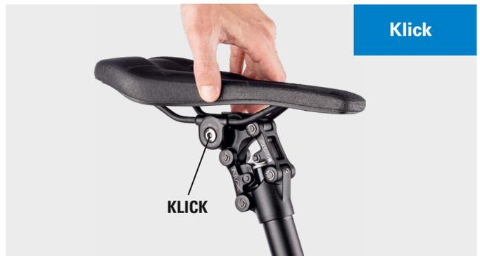
4. Richten Sie den Sattel so aus, dass er zentriert ist und die Oberseite horizontal ist (empfohlen), wie in der Abbildung rechts gezeigt.
