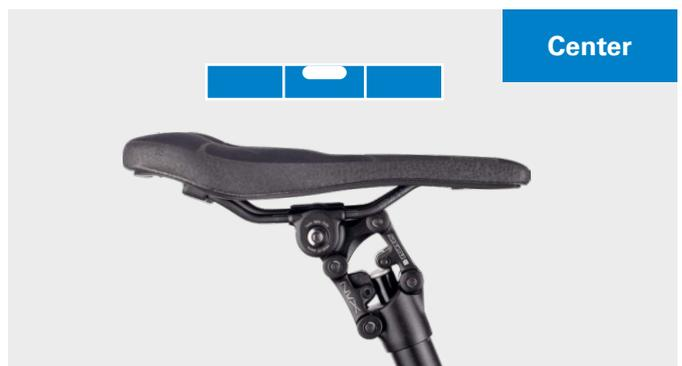
5. Apriete el tornillo de fijación con una llave Allen de 5 mm. El par de apriete sugerido es de 15-18 Nm.
