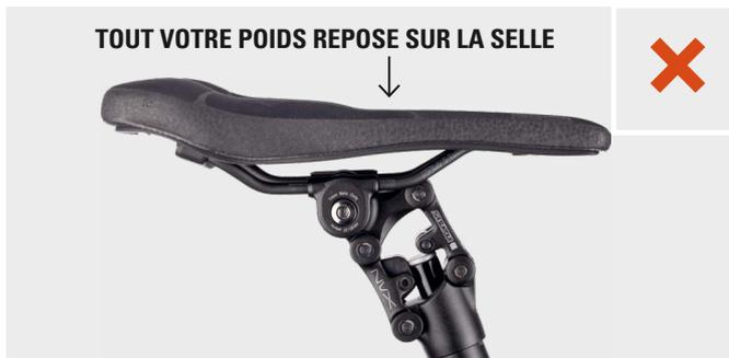
2. Pour augmenter la précharge, à l'aide d'une clé Allen de 6 mm, tournez le dispositif de réglage dans le sens des aiguilles d'une montre. Pour diminuer la précharge, tournez le dispositif de réglage dans le sens inverse des aiguilles d'une montre, en prenant soin de laisser un minimum de 10 mm de filetage exposé visible au bas de la tige de selle. Voir ci-dessous :
