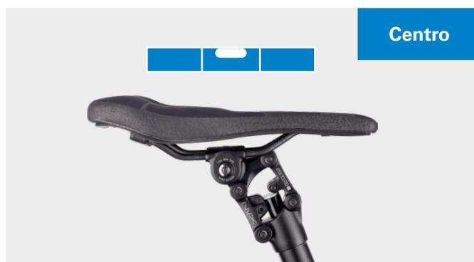
5. Serrare la vite di fissaggio con una chiave a brugola da 5 mm. La coppia di serraggio consigliata è di 15-18 Nm.
