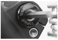
1. Schieben Sie die Achse hinein und ziehen Sie sie mit einem 6mm Innensechskantschlüssel auf 10Nm an.
