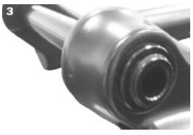
3. Überprüfen Sie das Gewinde der Achse. Es muss sichtbar sein.
