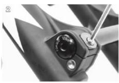
2. Ziehen Sie die Sicherungsklemme mit einem 4mm Innensechskantschlüssel auf 7Nm an.
