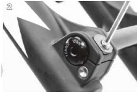
2. Serrare il morsetto di sicurezza a 7Nm con una chiave a brugola da 4mm.
