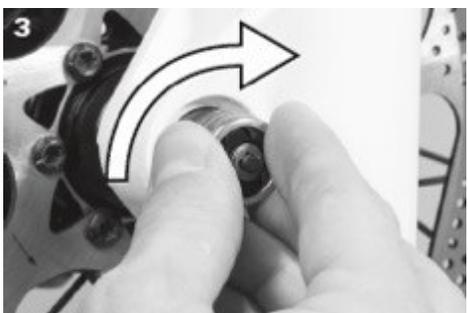
3. Aprire completamente la leva. Ruotare il dado in senso orario finché la flangia non rimane fissata.
