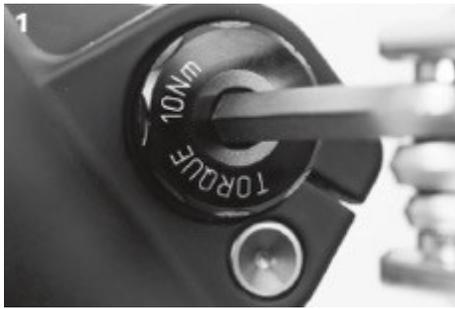
1. Inserire l'asse e serrarlo a 10 Nm con una chiave a brugola da 6mm.
