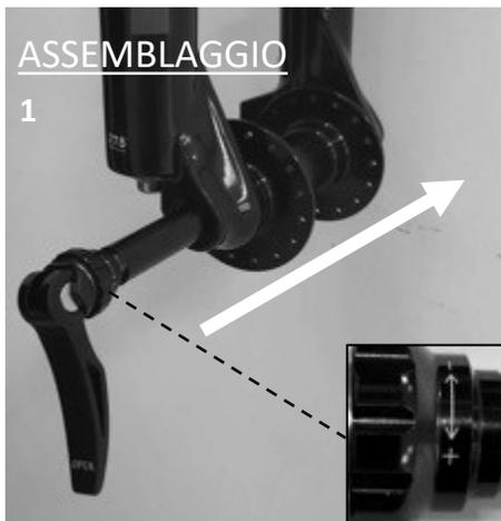
1. Dopo aver ruotato il dado di regolazione in direzione "4" fino all'arresto, inserire la ruota nella forcella e inserire il perno con la leva in posizione aperta.
