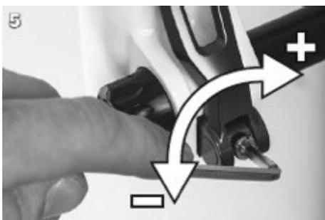
5. Ajuste la fuerza de tensado con una llave Allen de 4 mm, en caso necesario.
