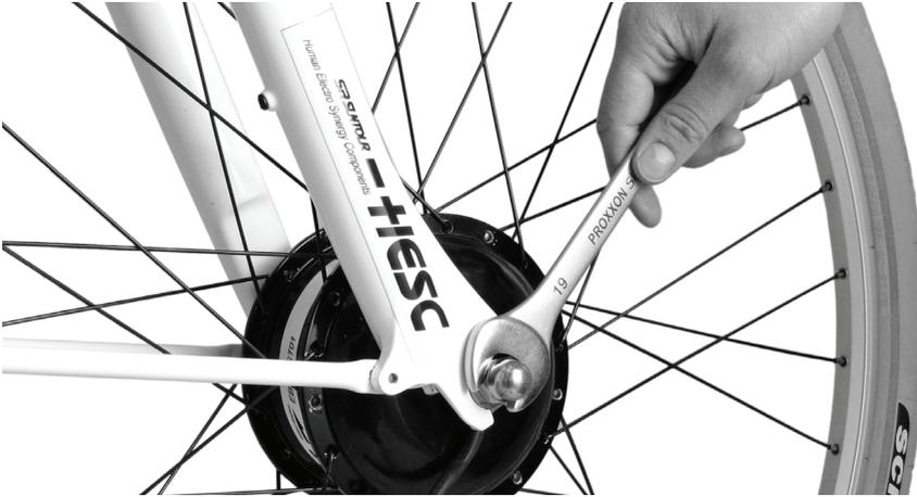
4. Bevor sie das Vorderrad ausbauen, entnehmen sie die Unterlegscheibe welche die Achse fixiert.
