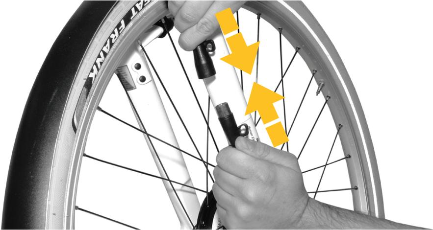
4. Montieren sie die Kabelführung und befestigen sie sie mit 4mm Imbusschlüssel. Ziehen sie die Schrauben mit 1Nm fest.
