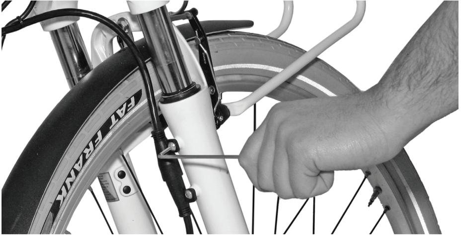
2. Lösen sie die Kabelverbindung
