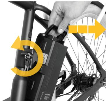
laden werden. Nach jeder Benutzung des Fahrrades sollte die Batterie ebenfalls voll aufgeladen werden. Unabhängig vom Ladezustand, kann die zu jedem Zeitpunkt aufgeladen werden. Ein voller Ladedurchgang dauert, abhängig vom Zustand der Batterie, zwischen 4 - 4.5 Stunden
