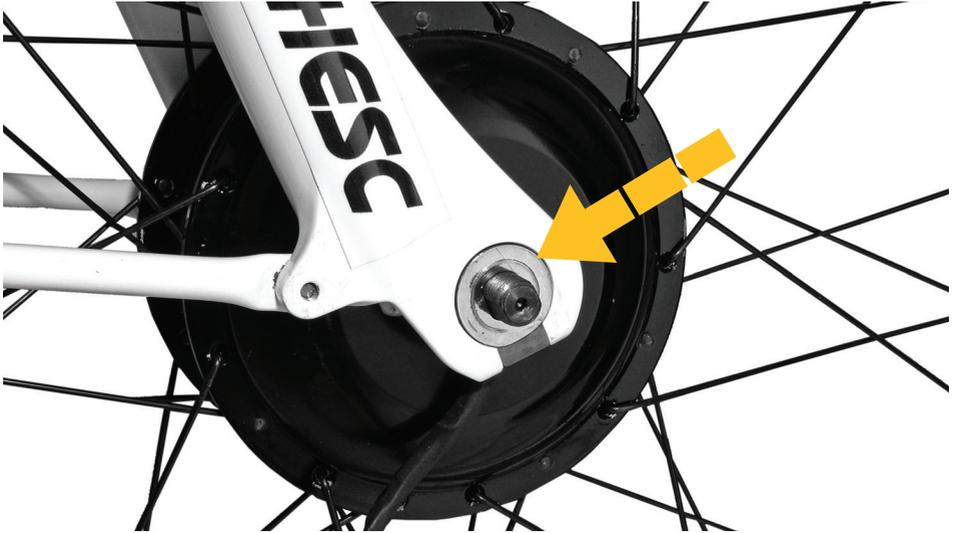
2. Ziehen sie die Achsmutter mit 25-30Nm an. Benutzen sie einen 19mm Gabelschlüssel.
