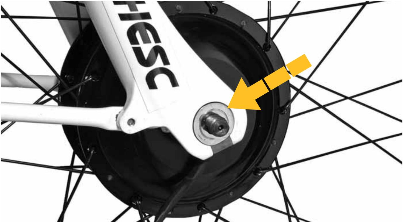
2. Serrez le boulon de fixation à un couple de 25-30 Nm avec une clé plate.
