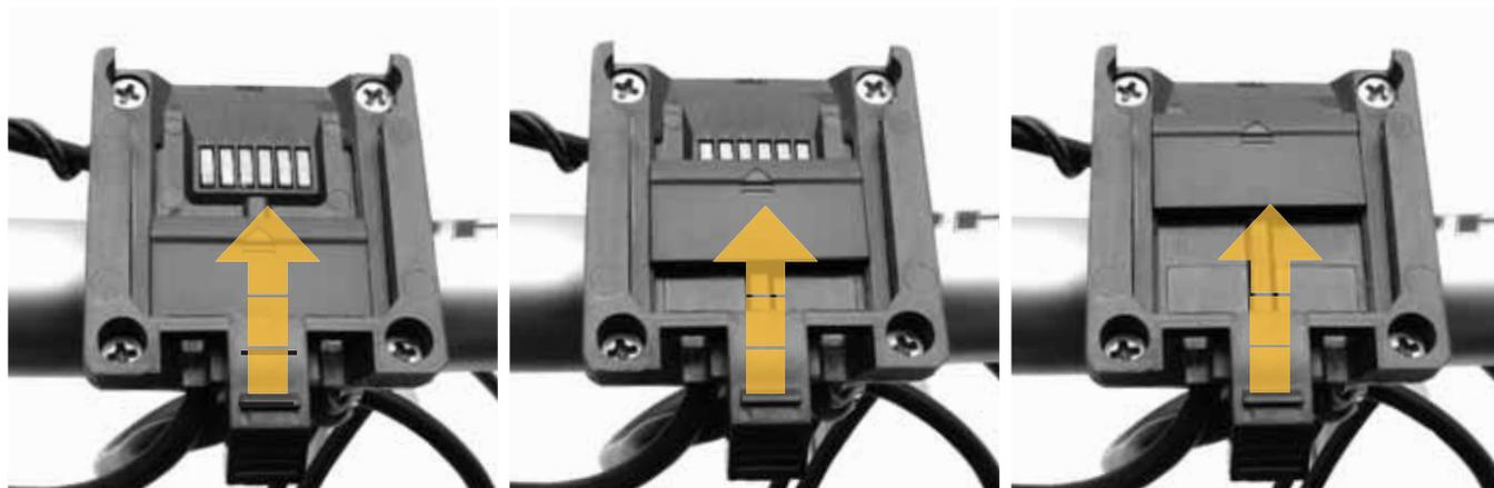
Le connecteur du socle de synchronisation est équipé d'un couvercle qui permet de protéger ses broches contre l'humidité et la crasse, en le faisant glisser par-dessus. Veillez à toujours recouvrir les broches après avoir retiré l'affichage !
