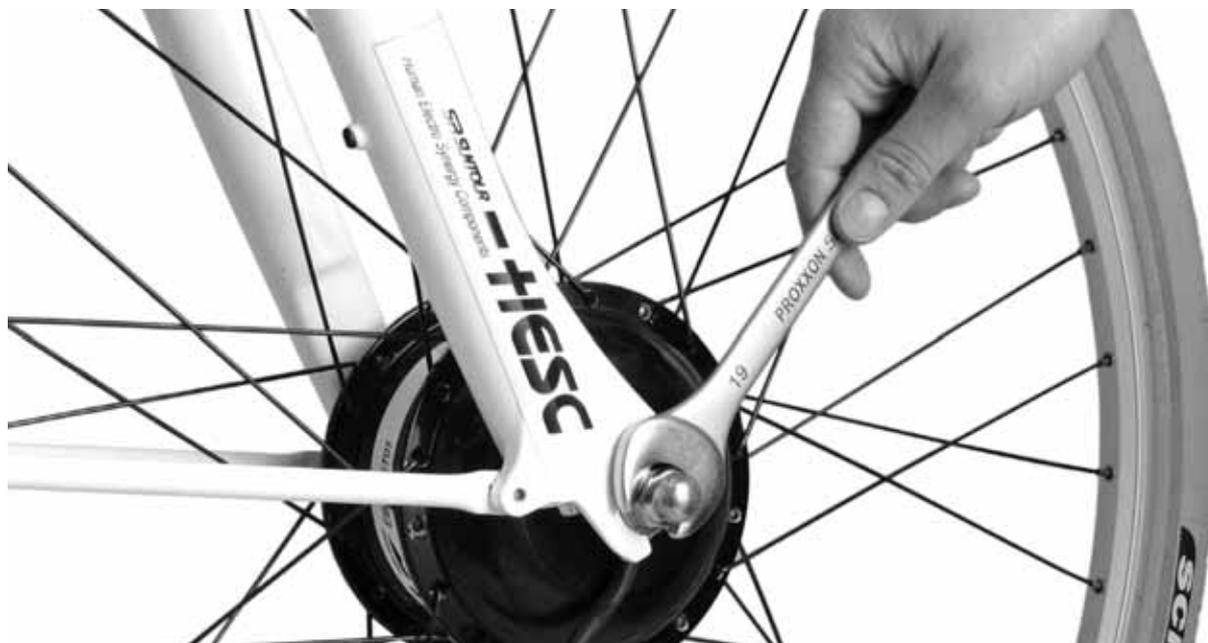
4. Déposez ensuite la rondelle de fixation de l'essieu avant de retirer la roue avant.
