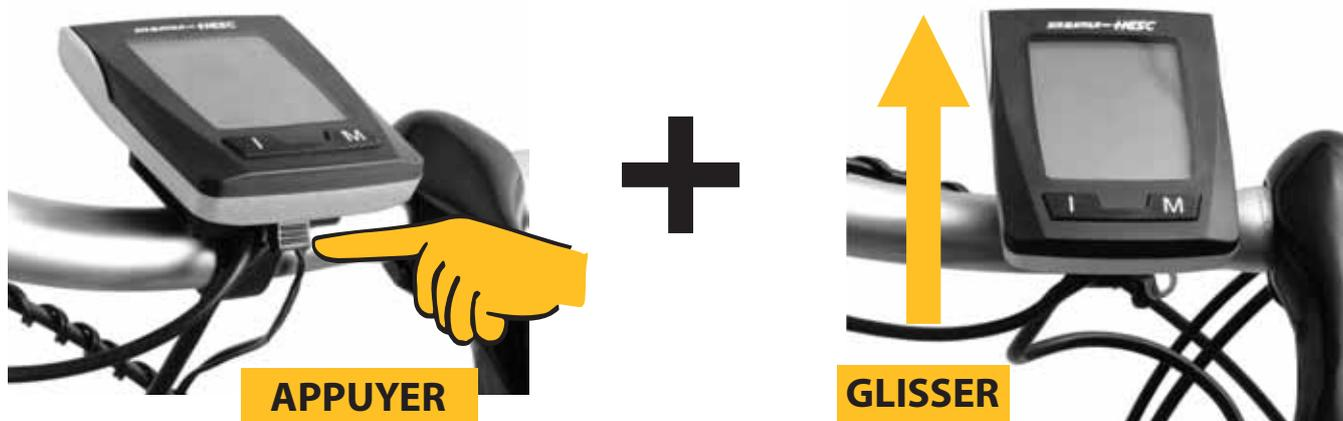
Veillez suivre la procédure précédente pour retirer l'affichage de son socle de synchronisation. Faites glisser l'affichage dans le socle de synchronisation pour le mettre en place.
