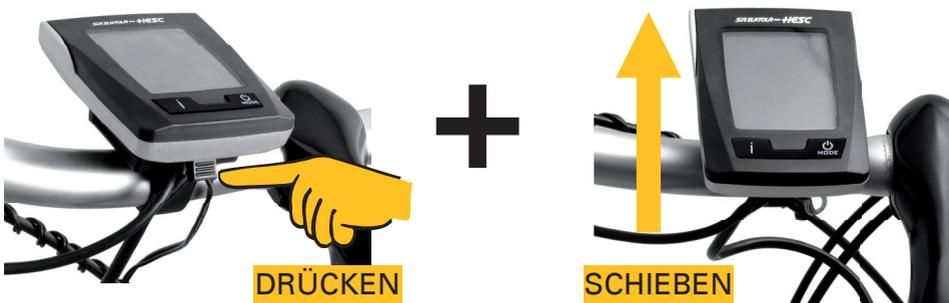
**! Schließen Sie immer die Abdeckung nachdem Sie das Display entfernt haben. Schalten Sie das System zuvor immer ab. !**
