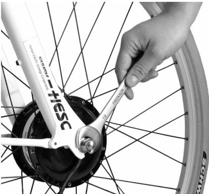
4. Entnehmen sie die Unterlegscheibe welche die Achse fixiert
