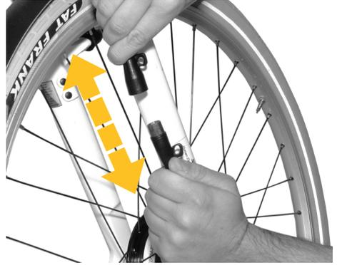
3. Lösen sie die Achsmutter mit einem 19mm Gabelschlüssel
