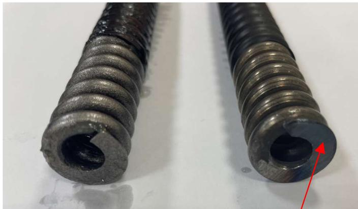
An beiden Federenden des gefälschten Produkts sind sichtbare Schleif- und Brandspuren zu sehen
