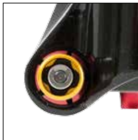
QLC: Q-LOC-2. Axe de 15 mm rapide breveté
