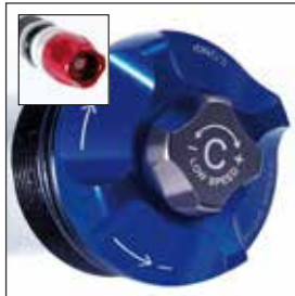
RC2: High & Low speed Druckstufenverstellung
