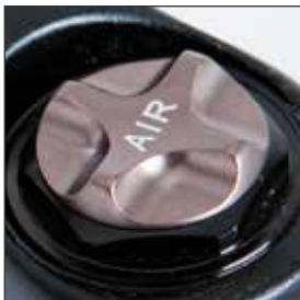
Air: Réglage pré-charge air
